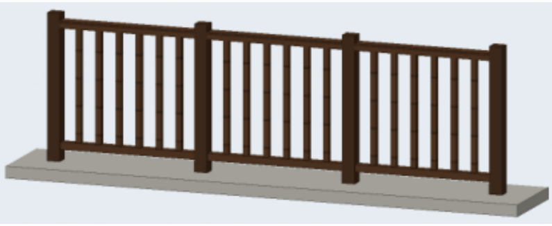
قوائم رأسية متقاربة (صورة 1)
